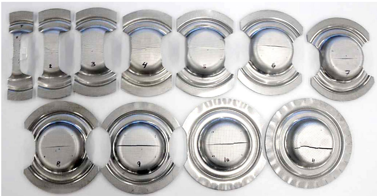
Figura 5. Exemplo de um conjunto de amostras marcadas superficialmente e formadas por um punção plano para obtenção da CLC [20].
