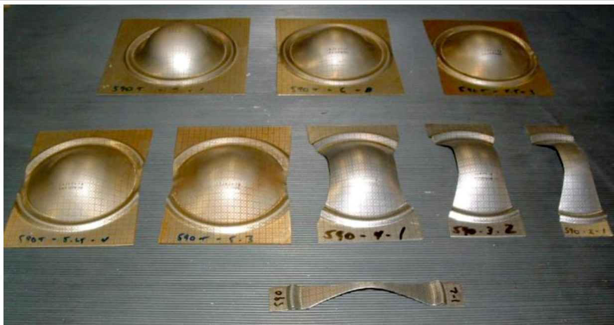
Figura 4. Exemplo de um conjunto de amostras marcadas superficialmente e formadas por um punção hemisférico para obtenção da CLC [17].
