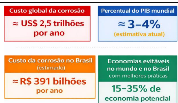
Figura 8. Estimativas da perda gerada pela corrosão, com base em dados da AMPP/NACE [19, 20].
