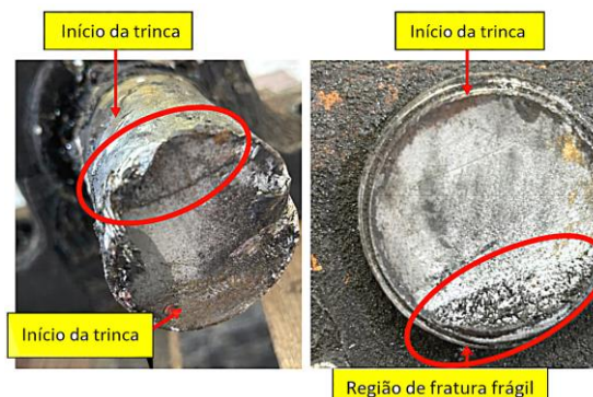
Figura 11. Aspecto da fratura nos eixos dos tambores 03 e 04 do extrator de metais (Figura 10).
